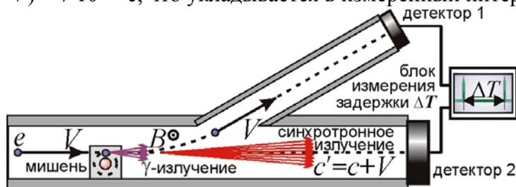
Рис. 9. Схема опыта Брауна.
