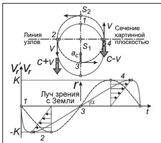
Рис. 2. Схема искажения видимого движения звезды по орбите с эксцентриситетом e = 0 и наклонением i = 90^\circ (у звезды, летящей по круговой орбите (пунктирная линия), влияние орбитальной скорости V на скорость света c ведёт к перекосу графика лучевых скоростей (сплошная линия), т.е. к появлению мнимого эксцентриситета e' и В-эффекта)
