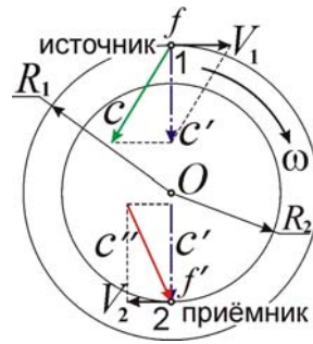
Рис. 3.20. Схема изменения скорости света на роторе и длины волны при измерении по эффекту Мёссбауэра.
