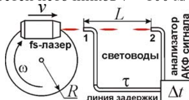
Рис. 2.4. Схема установки по измерению скорости света от подвижного fs -лазера.
