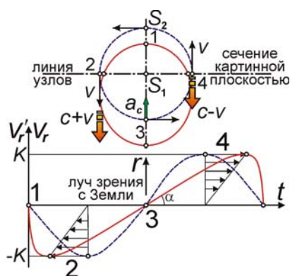
Рис. 1.3. Схема искажения видимого движения звезды по орбите с эксцентриситетом e = 0 и наклонением i = 90^\circ . У звезды, летящей по круговой орбите ( пунктирная линия ), влияние орбитальной скорости V на скорость света c ведёт к перекосу графика лучевых скоростей ( сплошная линия ), т.е. к появлению мнимого эксцентриситета e' и В-эффекта.
