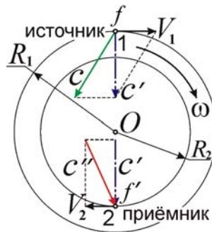
Рис. 3.23. Схема изменения скорости света на роторе и длины волны при измерении по эффекту Мёссбауэра.
