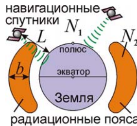
Рис. 2.32. Схема радиационных поясов Земли и GPS-радиолокации.
