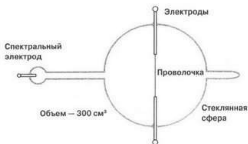
Схема разрядно-взрывной камеры Айриона и Вендта (эксперимент 1922 года)
