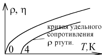
Рис. 177. Вязкость газа при снижении температуры T падает до нуля, равно как сопротивление металла, пропорциональное вязкости электронного газа.
