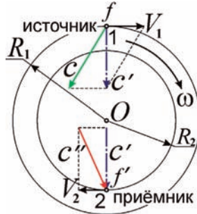
Рис. 4.1. Схема изменения скорости света на роторе и длины волны при измерении по эффекту Мёссбауэра (источник и приёмник-поглотитель не строго диаметрально противоположны – изображены в разные моменты – излучения и поглощения).
