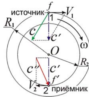
Рис. 4.1. Схема изменения скорости света на роторе и длины волны при измерении по эффекту Мёссбауэра.
