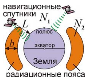
Рис. 2.33. Схема радиационных поясов Земли и GPS-радиолокации.
