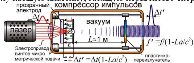
Рис. 3.10. Инерционный преобразователь частоты и компрессор импульсов, действующий по принципу ускорения излучающих и переизлучающих частиц электрическим полем E .
