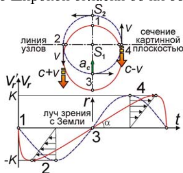
Рис. 1.3. Схема искажения видимого движения звезды по орбите с эксцентриситетом e = 0 и наклонением i = 90^\circ . У звезды, летящей по круговой орбите (пунктирная линия), добавление орбитальной скорости V к скорости света c приводит к перекосу графика лучевых скоростей (сплошная линия), т.е. к появлению мнимого эксцентриситета e' и В-эффекта.
